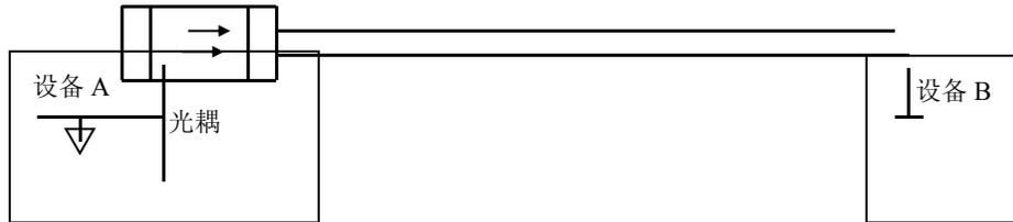
② 使用屏蔽线:(安装工艺文件及材料配置表一般有要求使用屏蔽线) 控制信号传输时虽使用了光耦隔离,但如果传输距离较远(大于10米)或有干扰线并行时,一般要求使用屏蔽线(单端接地)。如下图:
