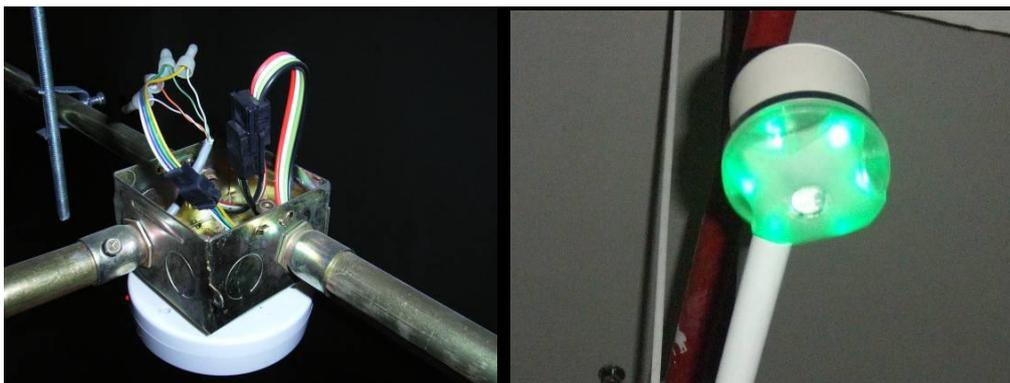
485 通讯采用的布线方式是手拉手方式，因此，从节点控制器出来的线一般有四股线，如果几个节点放置在一块，则此处布线共用的管穿过的线将倍增，对应的管不能太小（例 KGB 管
