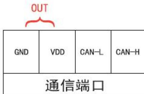
(4) 全控端口的连接端子如图:
