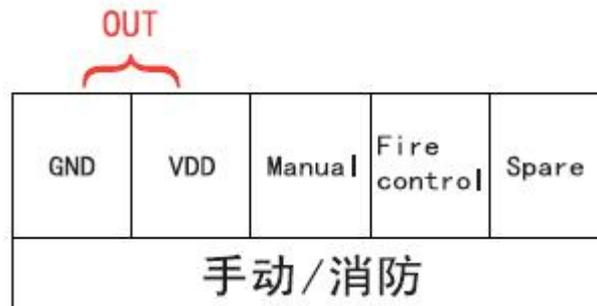
(3) 远程通信端口的连接端子如图:
